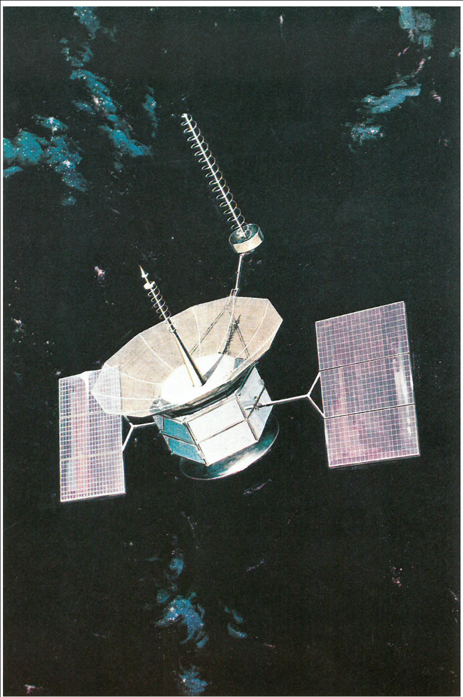
الشكل (٢): قمر صناعي في مداره الثابت، وتظهر الهوائيات والمصفوفات الشمسية.
